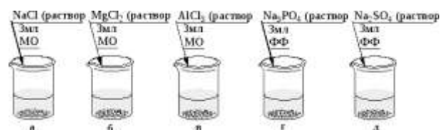
Рис. 18. Порядок проведения опыта: а – д – пробирки. Характер среды в пробирках а, б, в и д проверяют метилоранжем (МО), в пробирке г – фенолфталеином (ФФ).
