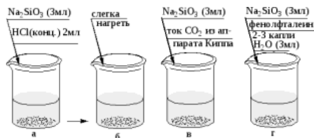
Рис. 17. Порядок проведения опытов: а – г – пробирки с раствором жидкого стекла \text{Na}_2\text{SiO}_3 . Газообразный углекислый газ получают из аппарата Кипа. В пробирке проверяют характер среды введением в раствор жидкого стекла при помощи фенолфталеина.
